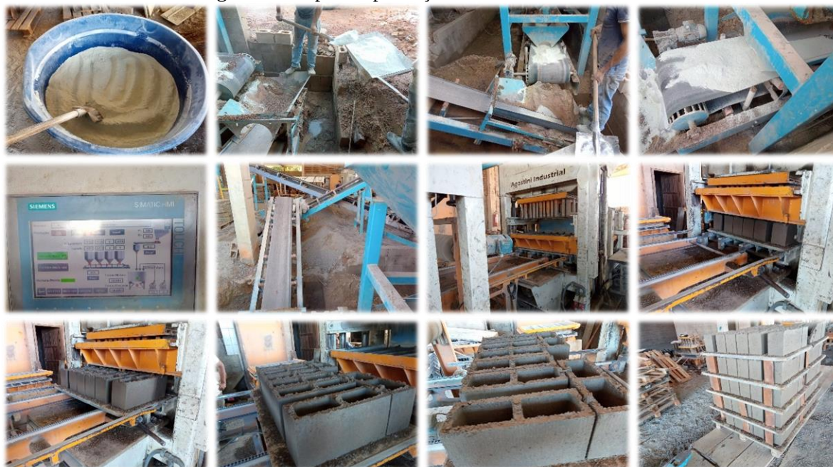
Figura 6 - Etapas da produção dos blocos de concreto
